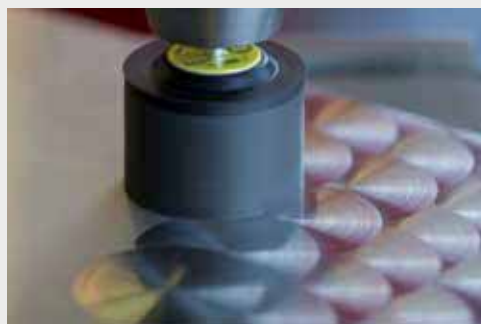
Przykład szlifowania ozdobnego za pomocą wersji marmurkowej R-Flex SFM 656 na blasze ze stali szlachetnej.
