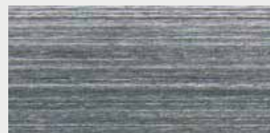
Ściernica listkowa nasadzana o granulacji 40 obraz szlif: linie długie, minimalne zagłębienia, gładkie wykończenie
