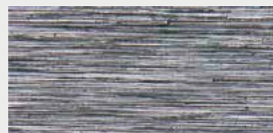
Pas bezkońcowy o granulacji 40 obraz szlif: linie krótkie, szorstka powierzchnia, chropowate wykończenie
